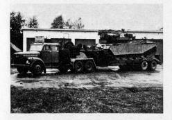
Die schwedische Armeematerialverwaltung hat einen Auftrag für eine große Anzahl von Zugwagen für Sattelschlepper erteilt. Diese werden vor allem für den Rücktransport beschädigter Tanks zur Reparaturstelle eingesetzt. Es handelt sich dabei um dreiachsige «Scania»-Zugwagen des Typs LT 110, bei denen beide Hinterachsen angetrieben werden. Sie sind mit verschiedenen Spezialausrüstungen versehen, unter anderem mit einer hydraulischen Doppelwinde mit einer Zugkraft von 2 × 20 t. WM
