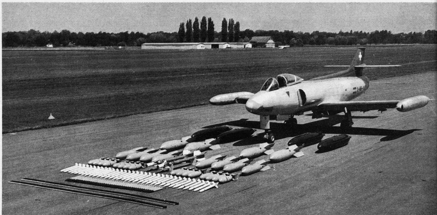
Bild 1: Erdkampfflugzeug P 16 Mk. III mit der Außenlastkonfiguration der AA 7 sowie mit Munition für die HS-Kanonen und den «Matra»-Raketenautomaten (1. und 2. sowie 3. Reihe vorn links).
