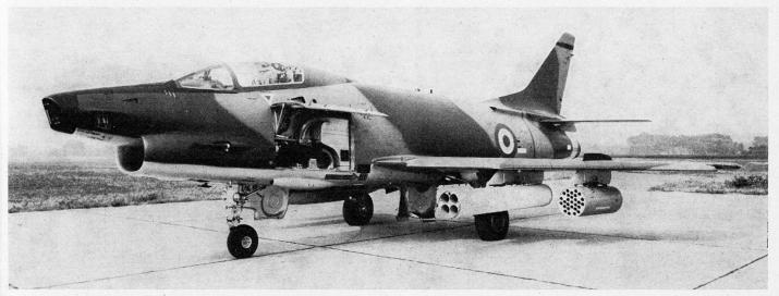
Bild 2. Fiat G 91 Y mit «Zuni»-Raketenwerfer 2 × 4 × 5" und «Breda-Matra»-Raketenwerfer 2 × 28 × 2" an den vier Außenstationen. Die linke, interne Waffenstation mit einer «DEFA»-Kanone 30mm ist abgedeckt.
