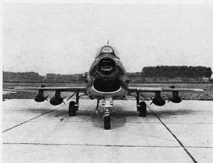
Bild 3. Fiat G 91 Y mit 2 \times 1000 -Pfund-Bomben an den inneren, und 2 \times 500 -Pfund-Bomben an den beiden äußeren Waffenstationen.
