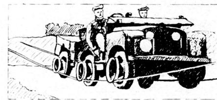
seile wurden als Spurbahn verlegt. An die Radnaben von leichten Fahrzeugen montierte man Profilscheiben (ähnlich den Keilriemenscheiben), mit denen die Seile befahren werden können.
