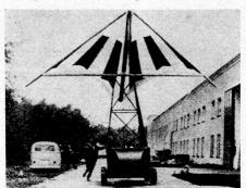
Landeplatz oder auch in größern Höhen ausgeklinkt. Eine einfache Abfangvorrichtung sorgt für weiches Aufsetzen. Größe: 6 m hoch und 8,5 m breit.
