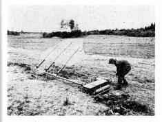
Bild 5. Mit dem Gerät BT 18 S läßt sich eine Panzerscheibe auf- und abklappen. Zur realistischen Darstellung eines schießenden Kampfwagens kann das Ziel mit einem Geschützfeuersimulator und einem Rauchgeber kombiniert werden.
