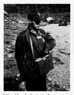
Bild 1. Über den Sender der Fernsteuerungsanlage BT 22 können sechsunddreißig verschiedene Manövrierbefehle erteilt werden.
