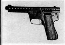
Bild 1. 13-mm-«Gyrojet»-Pistole, Ansicht von links. Die seitlichen Bohrungen gestatten das Austreten der Treibgase. Über dem Abzug erkennt man den Spannocken des Schlag-
