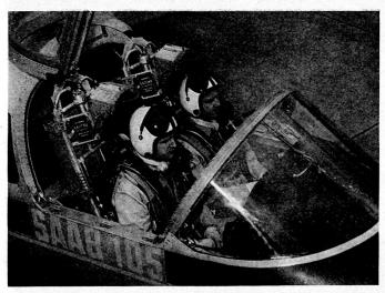
Bild 6. Blick in das Cockpit des leichten Trainings- und Erdkampfflugzeuges Saab 105 (A 60). Die Schleudersitze können gegen normale Sitze ausgetauscht werden, und im hinteren Teil lassen sich zwei weitere Sitze oder eine Sitzbank für zwei oder drei Personen unterbringen.
