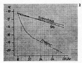
Bild 2. Nächtlicher Temperaturverlauf in zwei unbewohnten Schneebauten mit offenen Eingängen, verglichen mit dem Freiland.
