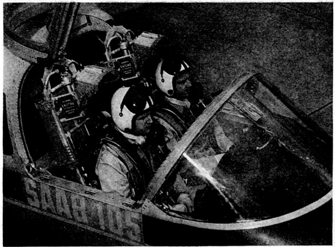
Bild 6. Blick in das Cockpit des leichten Trainings- und Erdkampfflugzeuges Saab 105 (A 60). Die Schleudersitze können gegen normale Sitze ausgetauscht werden, und im hinteren Teil lassen sich zwei weitere Sitze oder eine Sitzbank für zwei oder drei Personen unterbringen.
