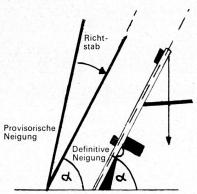
Bild 5. Mit Senkblei und Distanzmarke wird die Elevation für eine bestimmte Schußdistanz ermittelt, der Richtstab durch den Truppkameraden in die gleiche Neigung wie das Sturmgewehr gebracht und fest eingeschlagen.
