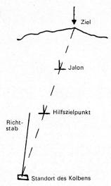
Bild 4. Richtstab, Jalon, Ziel und Hilfszielpunkt liegen auf einer Geraden. Die Elevation des Richtstabes ist vorläufig willkürlich.
