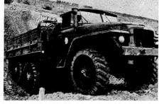
Bodenfreiheit 400 mm; Steigfähigkeit 65%; Watfähigkeit 1500 mm; Nutzlast im Gelände 4500 kg; maximale Geschwindigkeit 75 km/h; Fahrbereich 650 km; 8-Zylinder-Viertakt-Otto-Motor, 175 PS bei 3000 U/min. cs
