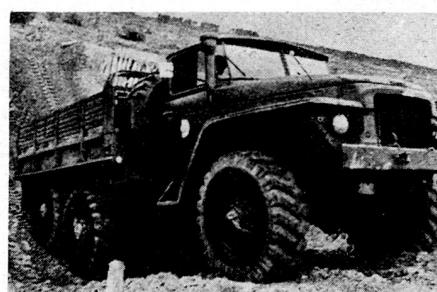
Bodenfreiheit 400 mm; Steifigkeit 65%; Watfähigkeit 1500 mm; Nutzlast im Gelände 4500 kg; maximale Geschwindigkeit 75 km/h; Fahrreich 650 km; 8-Zylinder-Viertakt-Otto-Motor, 175 PS bei 3000 U/min. cs
