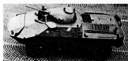
im Einsatz. Der FUG, eine Weiterentwicklung des sowjetischen Schwimm-Schützenpanzerwagens 40P, ist mit einem um 360° drehbaren Turm ausgestattet, in welchem sich eine 20-mm-Maschinenkanone befindet. Das Fahrzeug hat einen Csepel-Motor von 100 PS Leistung (Diesel) bei 2300 U/min. cs
