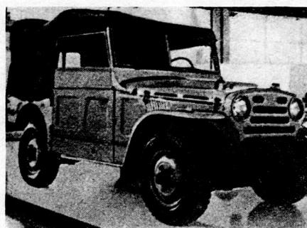
Sein Motor leistet 63 PS, die Höchstgeschwindigkeit liegt bei 116 km/h. Außer dem Fahrer finden noch sechs Personen und 50 kg Last Platz. cs
