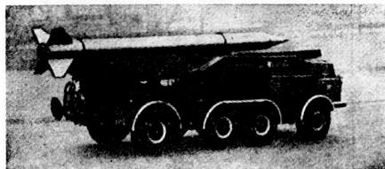
satz. Breite und hohe Niederdruckreifen, eine kurze, gedrungene Kabine und die langgestreckte Startschiene sind die äußersten Merkmale des zweckmäßigen modernen Trägerfahrzeugs. Das Projektil kann mit einem Abschusswinkel bis zu 90° gestartet werden. cs
