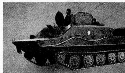
Bilder 4 und 5. BTR 50P, Ausführung 4, 1963, Führungs- und Funkpanzer.
