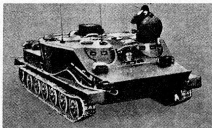
Bild 3. BTR 50P, Ausführung 3, 1962, Führungs- und Funkpanzer.
