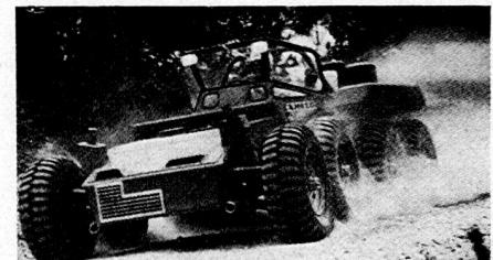
benes, mit Einzelradaufhängung versehenes geländegängiges Pneufahrzeug, das aus zwei in der Mitte aneinandergekoppelten Teilen besteht. Sein Wenderadius ist kleiner als derjenige des Jeeps. Nebst der sehr hohen Geschwindigkeit in rauhem Gelände erreicht der «Twister» auch auf der Straße eine beachtliche Geschwindigkeit von etwa 105 km/h. Die Fahrzeit aus dem Stillstand bis zum Erreichen von 75 km/h beträgt 18 Sekunden.
