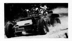
benes, mit Einzelradaufhängung versehenes geländegängiges Pneufahrzeug, das aus zwei in der Mitte aneinandergekuppelten Teilen besteht. Sein Wenderadius ist kleiner als derjenige des Jeeps. Nebst der sehr hohen Geschwindigkeit in rauhem Gelände erreicht der «Twister» auch auf der Straße eine beachtliche Geschwindigkeit von etwa 105 km/h. Die Fahrzeit aus dem Stillstand bis zum Erreichen von 75 km/h beträgt 18 Sekunden.
