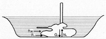
das heißt, hinzu kommt der Widerstand des Wassers  $(R_{\rm w})$ , dessen Größe von der Schnelligkeit der Bewegung abhängt. Unter Wasser fährt man meist im ersten Gang, das heißt mit 6 bis 7 km/h, dann übersteigt  $R_{\rm w}$  nicht 700 bis 800 kg. Die Größe des Widerstandes des Grundes hängt von seiner Beschaffenheit  $(f_1)$  und vom Haftgewicht  $(G_1)$  ab. Der erste Wert beträgt 0,12 bei sandigem Grund, 0,18 bei schlammigem Sand, 0,24 bei sumpfigem Grund.
