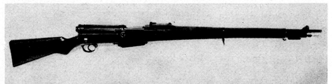
Bild 2. Selbstladegewehr (Rückstoßlader), System Hans Stamm, um 1914. Serie Nr. 32, Kaliber 7,5 mm, wie Mehrlader, Kastenmagazin (nicht abnehmbar) für 6 Patronen, mit Putzstock unter dem Lauf. Privatsammlung.
