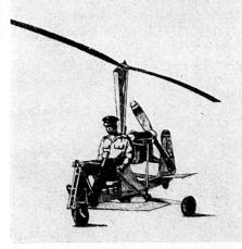
schrauber hat einen zweiblättrigen Rotor von 6,12 m Durchmesser. Angetrieben wird er von einem 65-PS-Motor, Typ «Walter-Mikron III», der auch die Stabilisierungsschraube bewegt. Als Höchstgeschwindigkeit wurden 165 km/h erreicht. Die Reisegeschwindigkeit beträgt 110 km/h. Die Reichweite beträgt 200 km. Der künftige Einsatz soll in der Aufklärung, Feuerleitung und auch im Kurierdienst bestehen. cs
