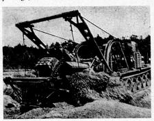
PS; Füllmenge je Schaufel 0,12 m³; Arbeitsgeschwindigkeit: 1. Gang 265 m/h, 2. Gang 570 m/h, 3. Gang 800 m/h, 4. Gang 1100 m/h; maximale Geschwindigkeit 33,5 km/h; Arbeitsgerät: Schaufelrad; Aushubtiefe bis 1,5 m. Der Grabenbagger gehört zu den Pioniermaschinen für Erdarbeiten. Er ist aus dem schweren Kettenschlepper AT-T hervorgegangen und wird in den Warschauer-Pakt-Armeen zum Ausheben von Schützen- und Verbindungsgräben eingesetzt.
