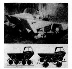
Sumpfgelände wie auch auf festem Untergrund und auf Straßen fahren kann. Von den «Haupträdern», die jeweils aus einem System von drei breiten Gummirädern bestehen, üben auf festem Grund nur zwei die Funktion von Reifen aus, während auf weichem Grund das ganze System als Rad funktioniert. Außer dem Fahrer können vier Mann Platz nehmen oder zwei Tragbahren oder 450 kg Nutzlast geladen werden. Wendung an Ort möglich. Länge 3,3 m, Breite 2,03 m, Höhe etwa I m.
