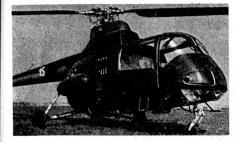
zweckhubschrauber, der als Verbindungs-, Transport- oder Sanitätsvariante eingesetzt werden kann. Mit Lastenaufzug (120 kp) versehen, ist seine Verwendung auch im Rettungsdienst möglich.
