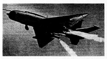
Bild 8. Jagdbomber mit Startbeschleuniger. Im Flug kurz nach dem Start mit sichtbaren Strahlen der Beschleuniger. («Prawda», 10. September 1967.)
