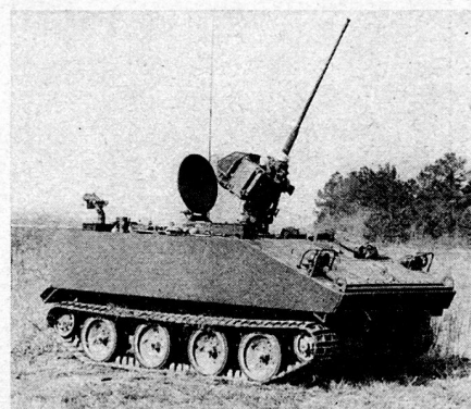
Aufklärungspanzer M 114 mit Maschinenkanone Hispano-Suiza. («Flugwehr und -Technik»)
