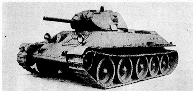
Bild 2. Kampfpanzer T 34 (76) A. Bei dieser Ausführung von 1941 fehlt die Kommandantenkuppel. Beachte die starke Abschrägung der Fahrerfront.
