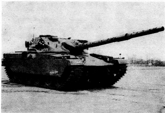
Bild 3. Der neue britische Kampfpanzer «Chieftain» zeichnet sich durch große Feuerkraft und gute Formgebung bei starker Panzerung aus. Das Kaliber der Kanone beträgt 120 mm, das Gewicht des Fahrzeuges etwa 45 t.
