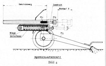
Konstruktion und Wirkung der Rohrrücklaufbremse
