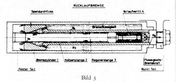
Die Funktion der Rücklaufbremse geht wie folgt vor sich: Beim Rücklauf wird entweder der Bremszylinder oder die Kolbenstange festgehalten, und der andere Teil ist mit dem rücklaufenden Rohr verbunden.
