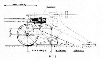
Man ließ dabei die Kanone mit den Rädern noch auf zwei lange Holzkeile auflaufen, wobei ein Teil der Rückstoßenergie auch noch durch Hubarbeit vernichtet wurde; zudem konnte die Kanone nach dem Rücklauf über die geneigte Bahn von selbst wieder einigermaßen in die Ausgangslage vorlaufen.
