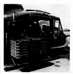
Bild 3. Luftraketenwerfer XM3 mit Spezialausrüstung für das Abfeuern von 288 AN-M8-Nebelkörpern vom Helikopter aus. In Höhen zwischen 60 und 90 m kann bei einer Geschwindigkeit von 75 bis 140 km/h ein 1000 m langer Nebelgürtel gelegt werden.
