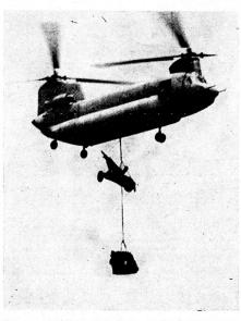
Bild 5. Lufttransport einer 105-mm-Haubitze XM 102 mit Munition zur Feuerstellung.
