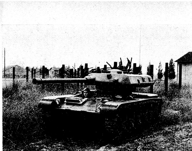
Bild 1. Kleinpanzer «Even» mit einer 90-mm-Kanone und einem Maschinengewehr.
