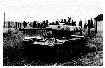
Bild 1. Kleinpanzer «Even» mit einer 90-mm-Kanone und einem Maschinengewehr.
