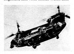
gebracht, einschließlich auf jeder Seite eine 20-mm-Kanone und entweder eine Gondel für 19 kleinere Raketen oder ein Schnellfeuermaschinengewehr 7,62. Fünf Schützen in der Kabine bedienen fünf Maschinengewehre auf Schwenklafetten, während auf der hinteren Laderampe eine mittelschwere Maschinenkanone montiert ist. Überdies sind die Sitze der Besatzung mit neuartigen Stahlpanzerplatten versehen. Ein Testtyp der «Chinook» soll in Kürze durch das Materialkommando des Heeres erprobt werden.
