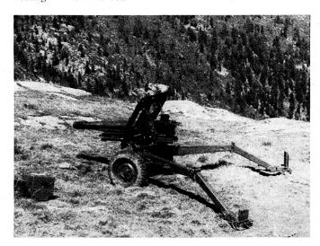
Bild I. Die italienische Gebirgshaubitze 105/14. Gewicht 1,27 t, V<sub>0</sub> 472 m/sec, Schußweite 10,2 km. Italienische Konstruktion, verfeuert Munition der US-IFH M-2; eingerichtet für Kraftzug, Pferdezug, Transport auf Tragtieren (12 Lasten, 116 bis 132 kg) und Mannschaftstransport. Verwendet in Gebirgs- und Luftlandeverbänden. GE: leichte Gebirgshaubitze 105 mm; IT: Obice da 105/14. Photo: Archiv Stabsakademie, Wien.
