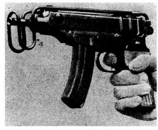
270 mm; theoretische Feuergeschwindigkeit 750 Schuß/min; praktische Feuergeschwindigkeit: Einzelfeuer 35 Schuß/min, Dauerfeuer 100 Schuß/min; günstigste Einsatzdistanz: als Maschinenpistole 200 m, als Pistole 50 m; Magazin für 10 Schuß (kurz), für 20 Schuß (lang).
