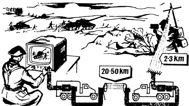
Empfänger für den Hauptmonitor und dem Stromaggregat. Unsere Skizze veranschaulicht das Arbeitsprinzip einer solchen Fernsehanlage.
