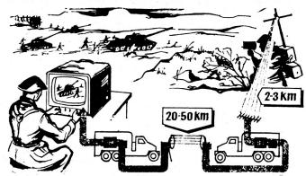
Empfänger für den Hauptmonitor und dem Stromaggregat. Unsere Skizze veranschaulicht das Arbeitsprinzip einer solchen Fernsehanlage.
