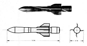
ROLAND: Fliegerabwehrwaffe auf unterer taktischer Stufe. Die Rakete weist Deltaflügel sowie zusätzliche Stabilisierungsflügel am vordern Teil auf. Abschuß erfolgt aus einem Abschußrohr, das gleichzeitig Transport- und Lagerungspackung darstellt.
