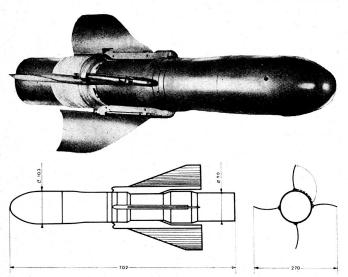
Lenkeinrichtung besteht aus Feuerauslösung, Zieloptik und Infrarot-Fernlenkanlage. Gleiche Präzision wie beim Einsatz aus fester Stellung ist auch beim Einsatz ab fahrendem Fahrzeug zu erwarten. Die Rakete erhält eine Rotation von 15 Umdrehungen pro Sekunde. Die Übertragung der Lenkkommandos erfolgt über einen mehradrigen Draht.
