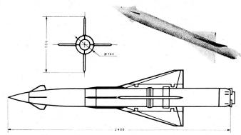
Das System soll auf einem leichten Raupenfahrzeug montiert werden. Vorgesehen sind zwei Rampen pro Fahrzeug mit automatischer Nachladung der Rampen. Das Fahrzeug soll lufttransportierbar sein. Die Verwendung der Rakete ist bei Sicht gegen Flugzeuge mit Geschwindigkeiten bis Mach 1,3 vorgesehen. Bedienung durch 3 Mann.
