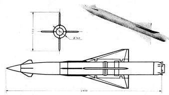
Das System soll auf einem leichten Raupenfahrzeug montiert werden. Vorgesehen sind zwei Rampen pro Fahrzeug mit automatischer Nachladung der Rampen. Das Fahrzeug soll lufttransportierbar sein. Die Verwendung der Rakete ist bei Sicht gegen Flugzeuge mit Geschwindigkeiten bis Mach 1,3 vorgesehen. Bedienung durch 3 Mann.
