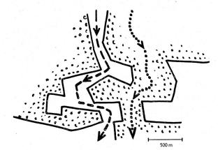
Bild 13. Sichtgedeckter Weg (punktiert) und trümmersicherer Weg (gestrichelt) in einer stark bewaldeten Zone.
