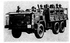
maximale Anhängergewichte auf Straßen 4400 kg, maximale Anhängergewichte im Gelände 3500 kg; maximale Geschwindigkeit 74 km/h; Motor S 47; Viertakt Otto, 6 Zylinder; Leistung 115 PS.
