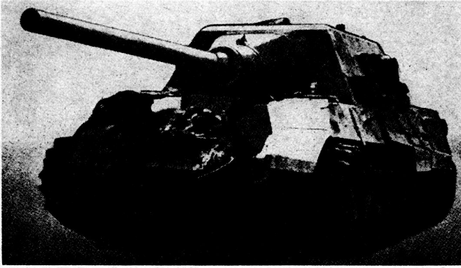
Bild 2. Jagdpanzer VI «Jagdtiger» mit 12,8-cm-Pak L/55.
