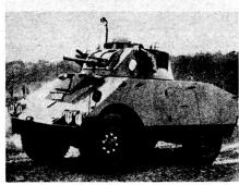
Bild 1: Ausführung A des Spähpanzers F.N. 4 RM/62 mit 90-mm-Kanone «Cati».
