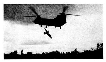
Bild 2. Boeing-Vertol CH-47 beim Transportieren einer 10,5-cm-Haubitze.
