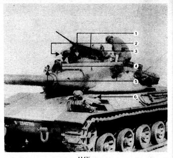
1. Zwei von fünf Winkelspiegeln in der drehbaren Kommandanten-Kuppel. 2. Halterung für Kommandanten-IR-Zielscheinwerfer für Flab.Mg., Reichweite 400 m. 3. IR-Rundblick-Zielfernrohr. 4. Halterung für IR-Zielscheinwerfer für 1200 m. 5. E-Meßgerät (Mischbild), 2 m Basis, Vergrößerung zwölffach, mit eingebautem Zielfernrohr, achtfach. 6. Fahrer-Winkelspiegel, drehbar. Gegen IR-Winkelspiegel austauschbar.
