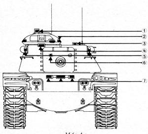
Kommandanten-Flab.Mg.-Zielfernrohr M 28 C. 2. Kinonblöcke in der Kommandanten-Kuppel M 19. 3. Ladeschützen-Winkelspiegel.
