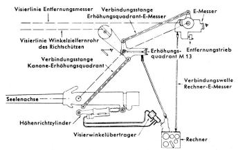
Bild 2. Schema der Visierwinkelübertragung.
