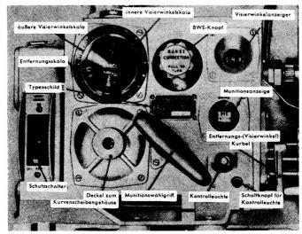
Bild 3. Das Rechengerät M 13 A 1.
