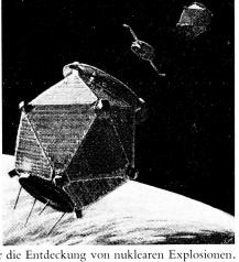
Bild 5. Satellit für die Entdeckung von nuklearen Explosionen.
