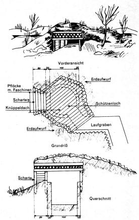
Bild 5. Russischer Erdbunker, Schützen- und Maschinengewehrstand.
