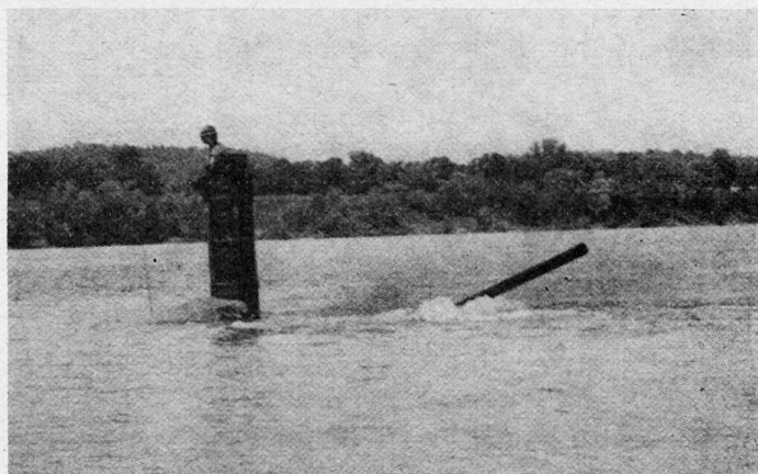
Bild 2. M60 während einer Unterwasserfahrt.
