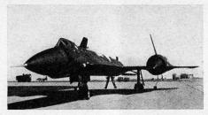
Unter dem mächtigen Bugradom aus hitzebeständigem Pyrozeram verbirgt sich der Radarreflektor der Feuerleitanlage. Sein Durchmesser wurde zwar nicht angegeben, dürfte aber rund I m betragen. Knapp hinter der geraden Schneide des keilförmigen Rumpfwulstes erkennt man einen der beiden Infrarotdetektoren und an der Oberseite des Rumpfhecks die geöffneten Klappen des Bremsfallschirmstauraumes.
