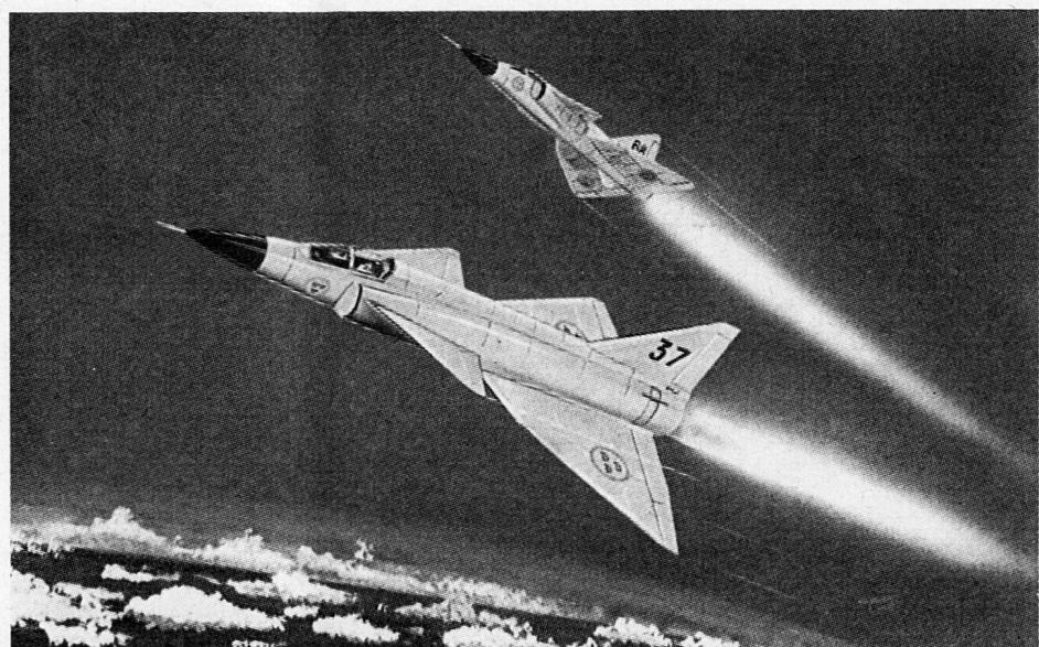
Aus dieser Zeichnung gehen die Grundzüge der «Viggen-Konfiguration» hervor. Bemerkenswert ist namentlich der hinter dem Cockpit installierte vordere Flügel, der die Sicht des Piloten in keiner Weise einschränkt. Diese Bauart soll beim Tiefflug mit hohen Geschwindigkeiten die beste Steuerbarkeit garantieren.
