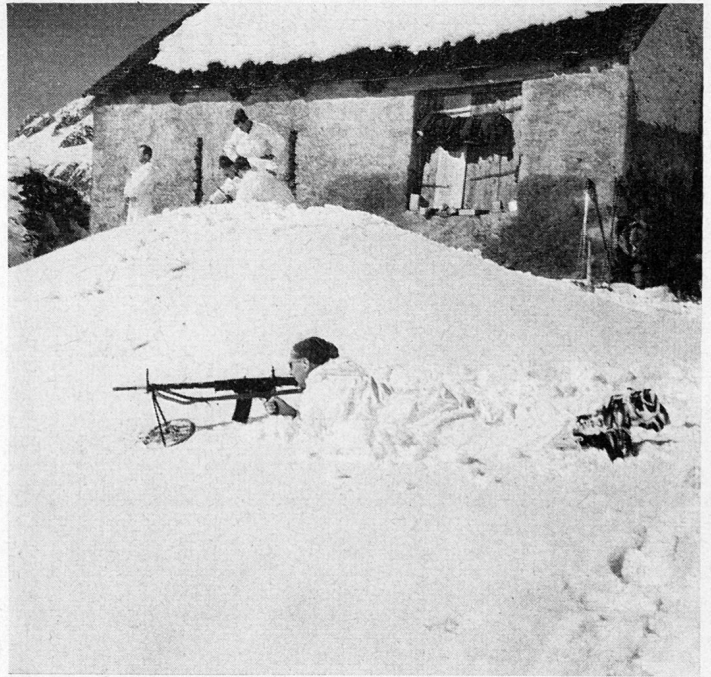
Bild 4. Standardlösung mit dem angebundenen Schneereifen. Die ungeschöne Neigung der Vorderstützen ist bedingt durch die relativ starre Verbindung der Stützenspitzen mit dem Schneereif sowie das Einsinken der Ellbogen in den Schnee.
