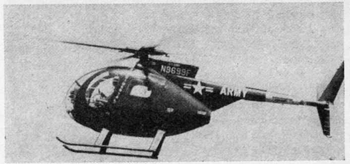
Bild 6. Der bisherige Aufklärungshelikopter OH 13 «Sioux» wird in nächster Zukunft durch den Hughes OH 6A ersetzt. Seine Ladekapazität von über 600 kg ist größer als sein minimales Eigengewicht; er kann somit 4 bis 6 Mann transportieren.
