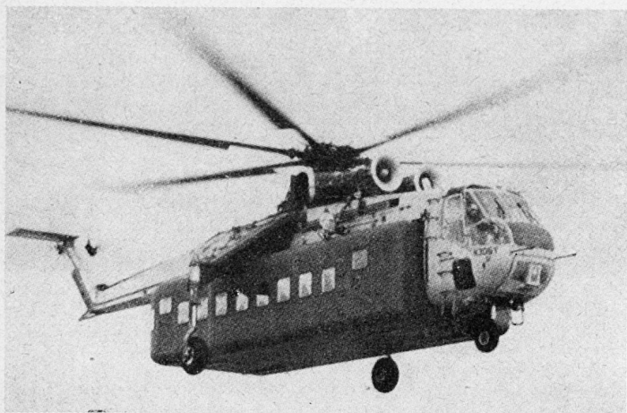
Bild 9. Eine vielseitige Verwendungsmöglichkeit bietet der CH 54 «Sky-crane» sowohl für Aufgaben des Transportes von Material, Mannschaft oder KP-Einrichtungen, wie dies im Bilde der Fall ist, als aber auch für die Evakuierung von beschädigten Helikoptern aus der Kampfzone.
