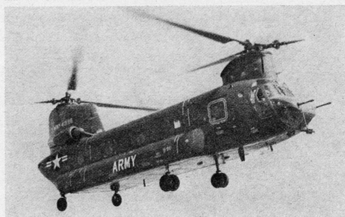
Bilder 4 und 5. Der mittlere Helikopter CH 47 «Chinook» kann 44 Mann oder eine Last von 4,5 t transportieren. Der CH 47 selbst kann wiederum im Transporter C 141 verladen werden.
