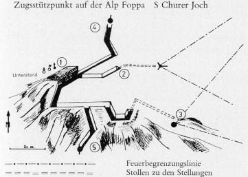
Die Anlage wurde in einem Tag ausgeschaufelt. Der Stützpunkt wurde so eingerichtet, daß nach der Fertigstellung ein Scharfschießen mit einer Gruppe und einem Maschinengewehr möglich war.
