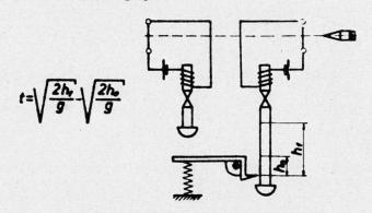
Bild 1. Prinzip des Kurzzeitmessers «Le Boulengé».
