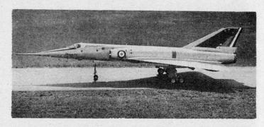
2. Der Dassault «Mirage III E» (Kampfflugzeug) erreicht in größeren Höhen doppelte Schallgeschwindigkeit und ist mit modernen Elektronikanlagen ausgerüstet (zu erwähnen ist der Radar «Cyrano 2 A»).
