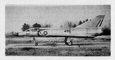
3. Der Prototyp «Mirage III V» stellt einen Senkrechtstarter als allfälliges zukünftiges Kampfflugzeug dar. Abheben mit Hilfe von acht Rolls-Royce-Hubturbinen.
