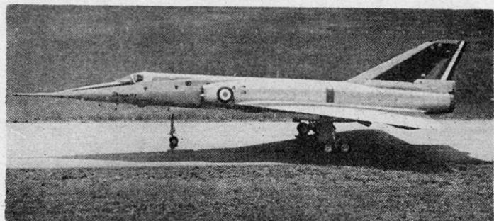
2. Der Dassault «Mirage III E» (Kampfflugzeug) erreicht in größeren Höhen doppelte Schallgeschwindigkeit und ist mit modernen Elektronikanlagen ausgerüstet (zu erwähnen ist der Radar «Cyrano 2 A»).
