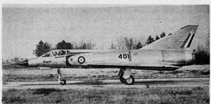
3. Der Prototyp «Mirage III V» stellt einen Senkrechtstarter als allfälliges zukünftiges Kampfflugzeug dar. Abheben mit Hilfe von acht Rolls-Royce-Hubturbinen.
