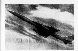
tenträger» bezeichnet. Auffallend sind der langgezogene, zigarrenförmige Rumpf und die Pfeilflügel mit vier Strahltriebwerken. Der Bomber hat ein Dreiradfahrgestell und trägt Luft/Boden-Raketen mit sich. Er soll ohne Zwischenlandung jeden Punkt der Erde erreichen können. Das Flugzeug ist mit zahlreichen Funkmeßgeräten und automatischen Instrumenten, auch solchen für Blindlandung, ausgestattet.
