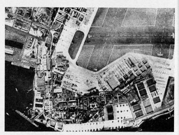
Aus einer Höhe von rund 21 km photographierte eine U2 die Naval Air Station in San Diego. Die Originalaufnahme soll ein Auflösungsvermögen von 15 cm besitzen. Derart «gestochen» scharfe Aufnahmen lassen sich mit Hilfe von Spiegelreflexobjektiven auch aus Satellitenhöhen machen, doch stellen sich hierbei Schwierigkeiten beim Ausrichten des Satelliten und bei der Geschwindigkeitskompensation ein.
