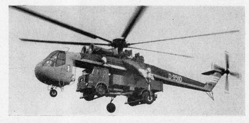
nere Laderaum wegfällt, kann der Kranhubschrauber eine sein Eigengewicht übersteigende Zuladung tragen. Zur Besatzung gehören drei Piloten, welche das etwa 8000 kg tragende Fahrzeug steuern.
