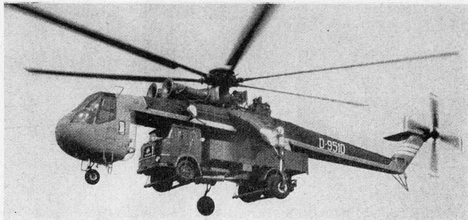
nere Laderaum wegfällt, kann der Kranhubschrauber eine sein Eigengewicht übersteigende Zuladung tragen. Zur Besatzung gehören drei Piloten, welche das etwa 8000 kg tragende Fahrzeug steuern. bb
