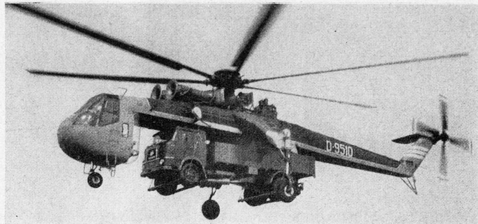
nere Laderaum wegfällt, kann der Kranhubschrauber eine sein Eigengewicht übersteigende Zuladung tragen. Zur Besatzung gehören drei Piloten, welche das etwa 8000 kg tragende Fahrzeug steuern.
