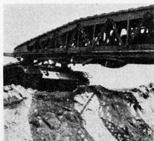
Der russische Brückenlegepanzer T-54/Br
