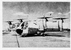
mit 1200 bis 2000 m/min angegeben. Um ein 20 m hohes Hindernis zu überwinden, wird die XC 142 A eine Startbahn von 130 m benötigen. Die Tests, denen dieser Typ nun unterzogen wird, dienen nicht mehr der Überprüfung des technischen Konzepts, sondern haben bereits die Abklärung des militärischen Einsatzes zum Ziele.
