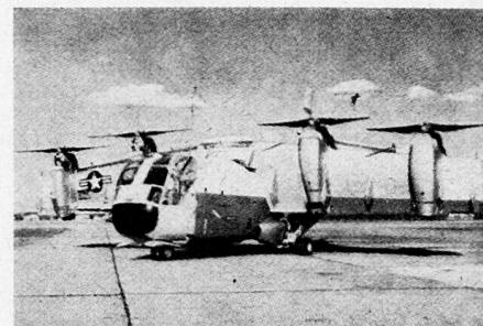
mit 1200 bis 2000 m/min angegeben. Um ein 20 m hohes Hindernis zu überwinden, wird die XC142 A eine Startbahn von 130 m benötigen. Die Tests, denen dieser Typ nun unterzogen wird, dienen nicht mehr der Überprüfung des technischen Konzepts, sondern haben bereits die Abklärung des militärischen Einsatzes zum Ziel.
