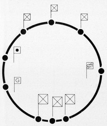
Bild 3. Das Mehrfachnetz (Verbindung jeder mit jedem)
