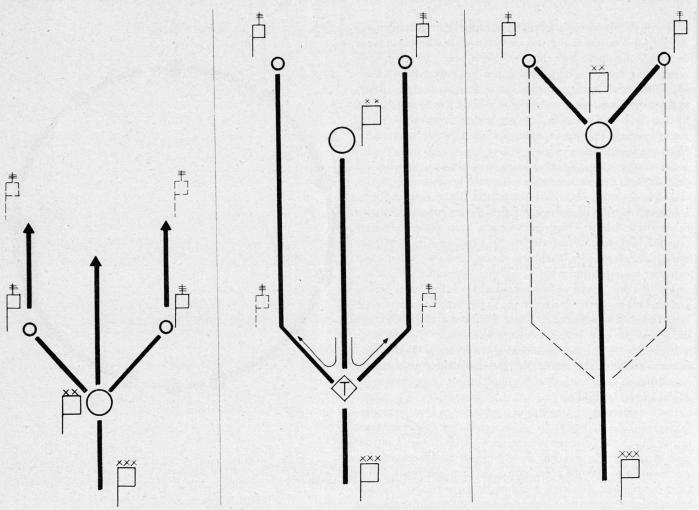
Bild 5. Aufbau des Drahtverbindungsnetzes in der Bewegung
