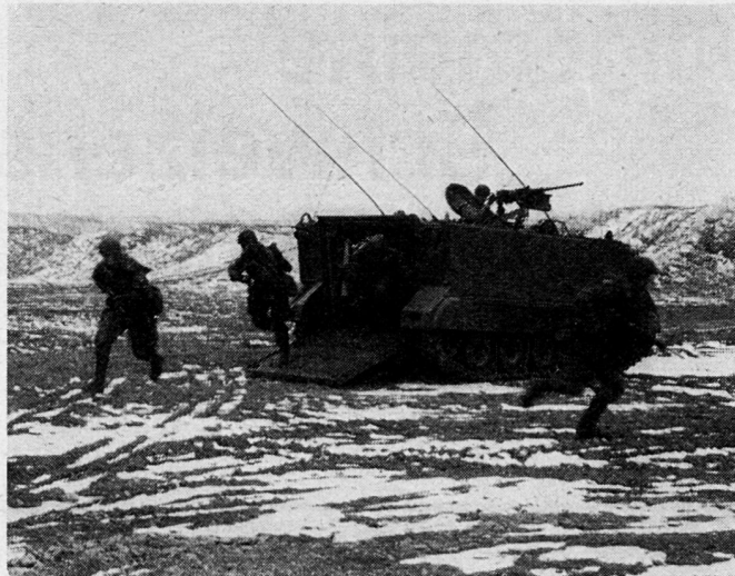
Bild 2. Die Gefechtsgruppe verläßt das Fahrzeug durch die große Hecktüre, die hydraulisch geöffnet wird, innerhalb einiger Sekunden.
