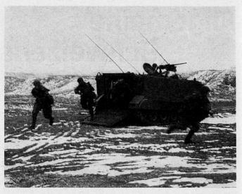
Bild 2. Die Gefechtsgruppe verläßt das Fahrzeug durch die große Hecktüre, die hydraulisch geöffnet wird, innerhalb einiger Sekunden.
