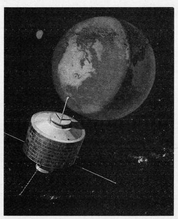
Bild 4. Der im Raum quasistationäre Satellit «Syncom» hält einen vorausbestimmten Längengrad inne. Auf Grund einer geneigten Umlauf bahn bewegt er sich jedoch 33 Grad nördlich und südlich bezüglich des Aquators.
